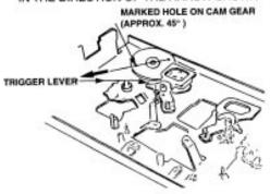
HOOK THE SPRING, TURN THE FR LEVER UPSIDE DOWN AND RE-INSTALL
