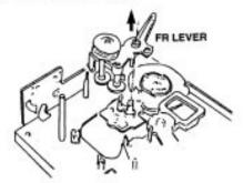
9. REMOVE THE TRIGGER LEVER
