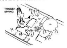
13. RE-INSTALL THE TRIGGER LEVER. SIDE A
